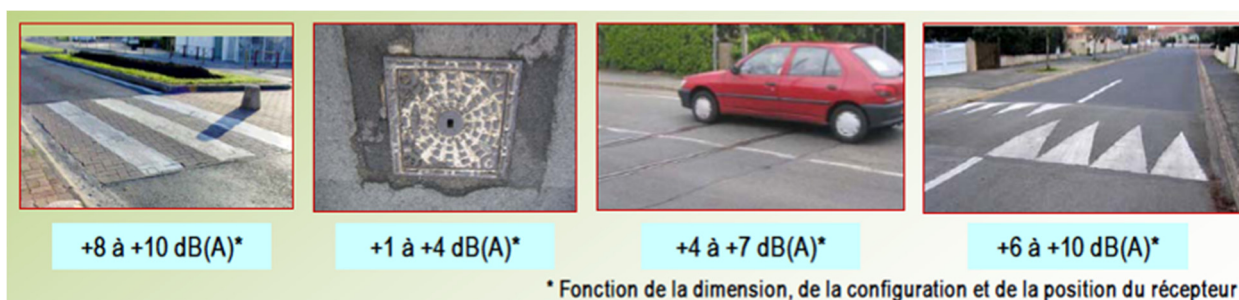
Exemples d'aménagements isolés et augmentation du niveau de bruit au passage associé (source LCPC)
